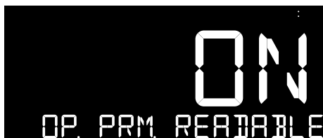
Fig. 31: lettura dei parametri di esercizio abilitata
