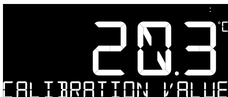
Fig. 37: valore della temperatura del termometro di riferimento
