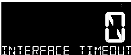
Fig. 24: monitoraggio del collegamento disattivato
