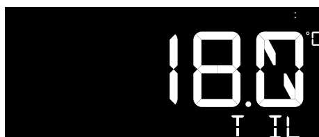
Fig. 19: impostazione del valore limite inferiore
